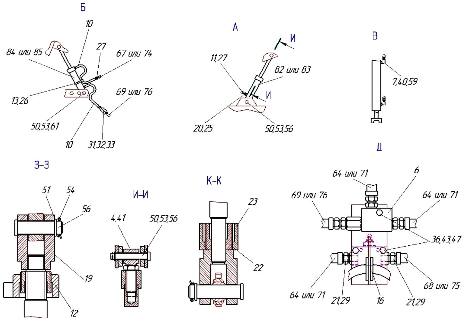
Рисунок 24в – Система гидравлическая ЖВЗ 9800000
