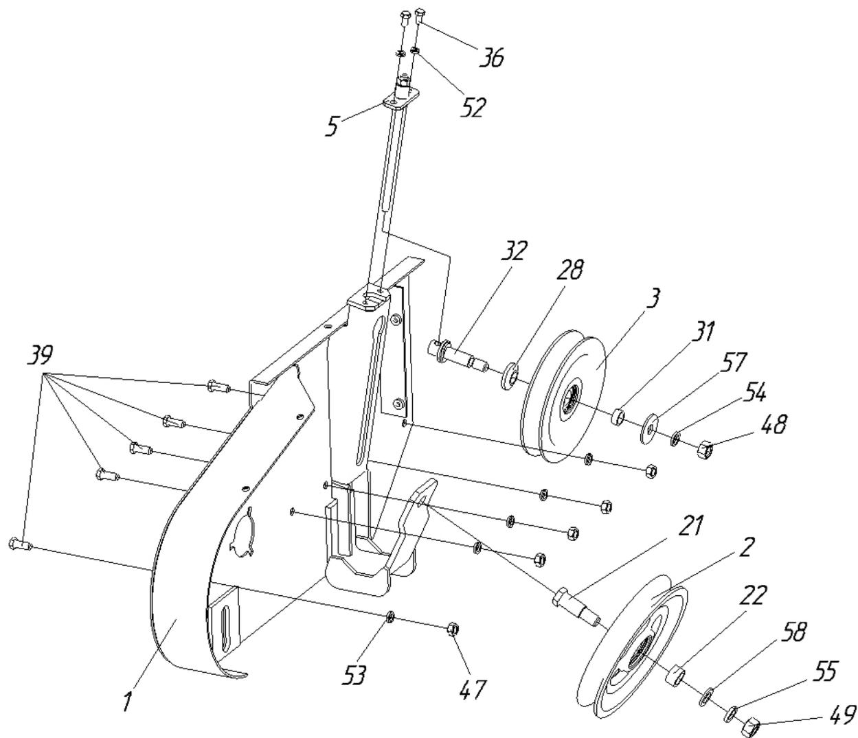
Рисунок 14в – Привод транспортеров ЖВЗ 9200000
