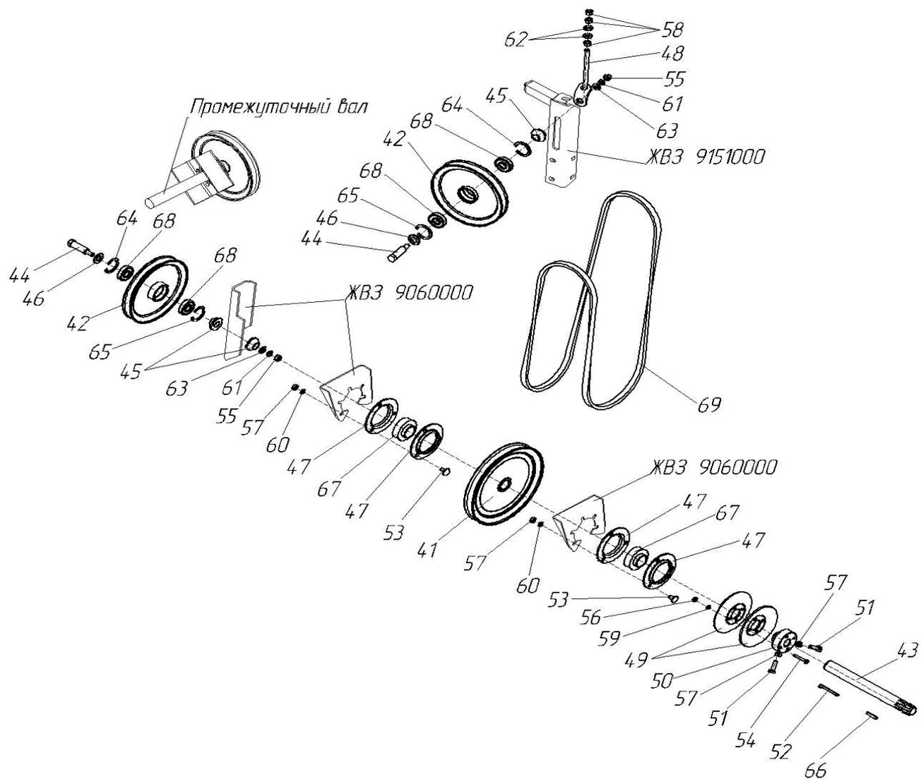
Рисунок 256 – Привод промежуточного вала
