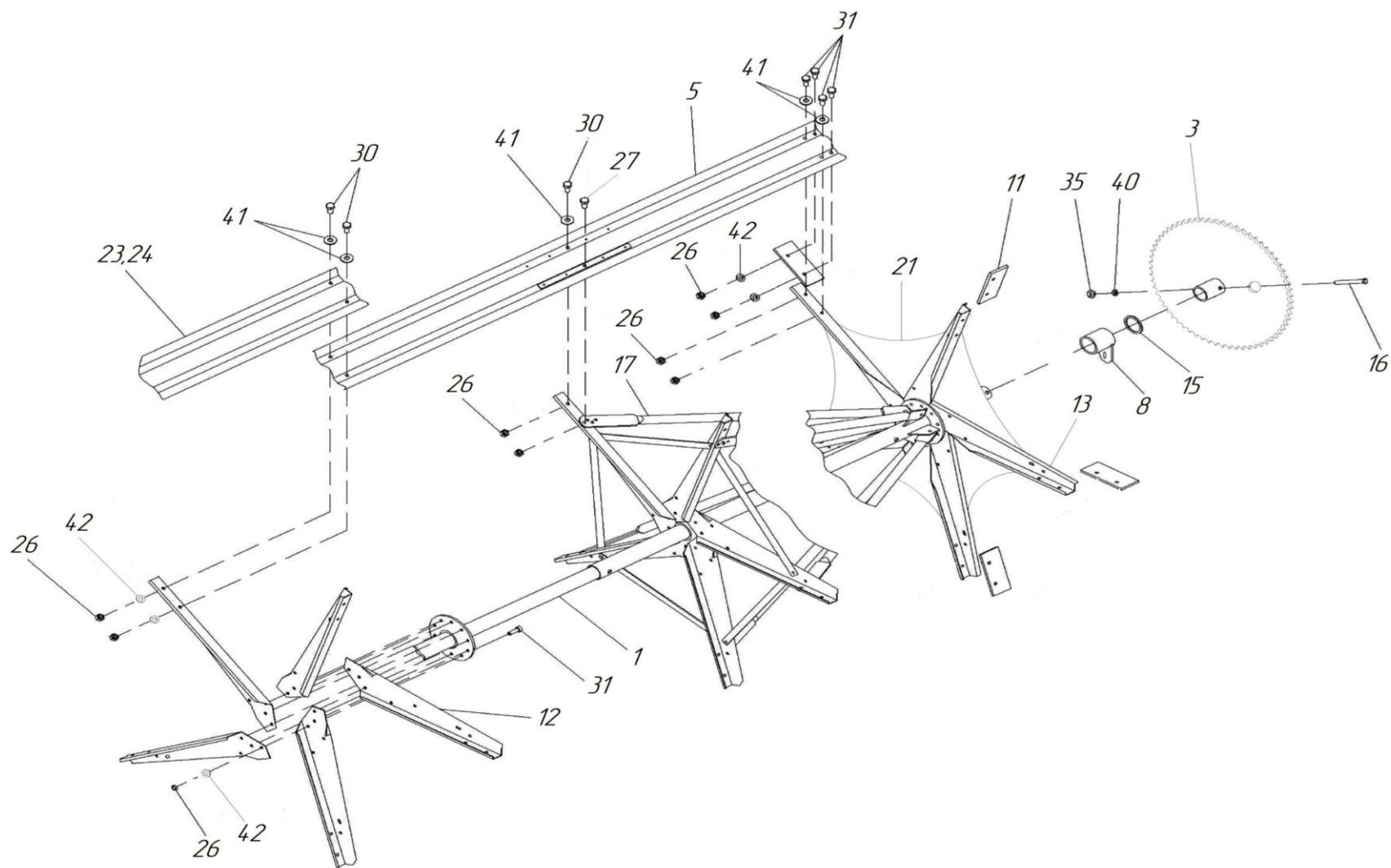
Рисунок 3б – Мотовило ЖВЗ 9030000 (левая часть)
