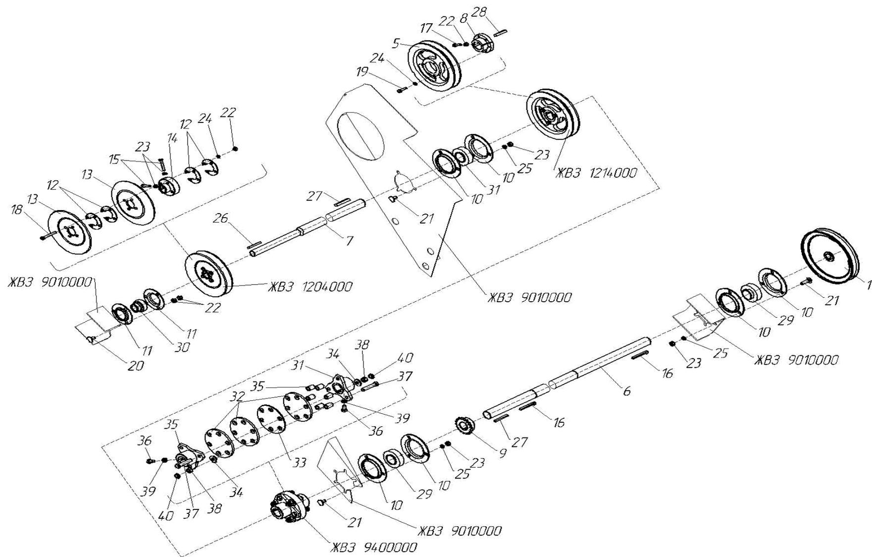
Рисунок 25а – Промежуточный вал в сборе
