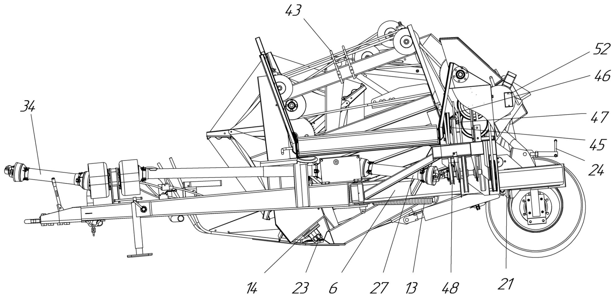
Рисунок 16 – Жатка валковая зерновая ЖВЗ-9,2 (вид слева)
