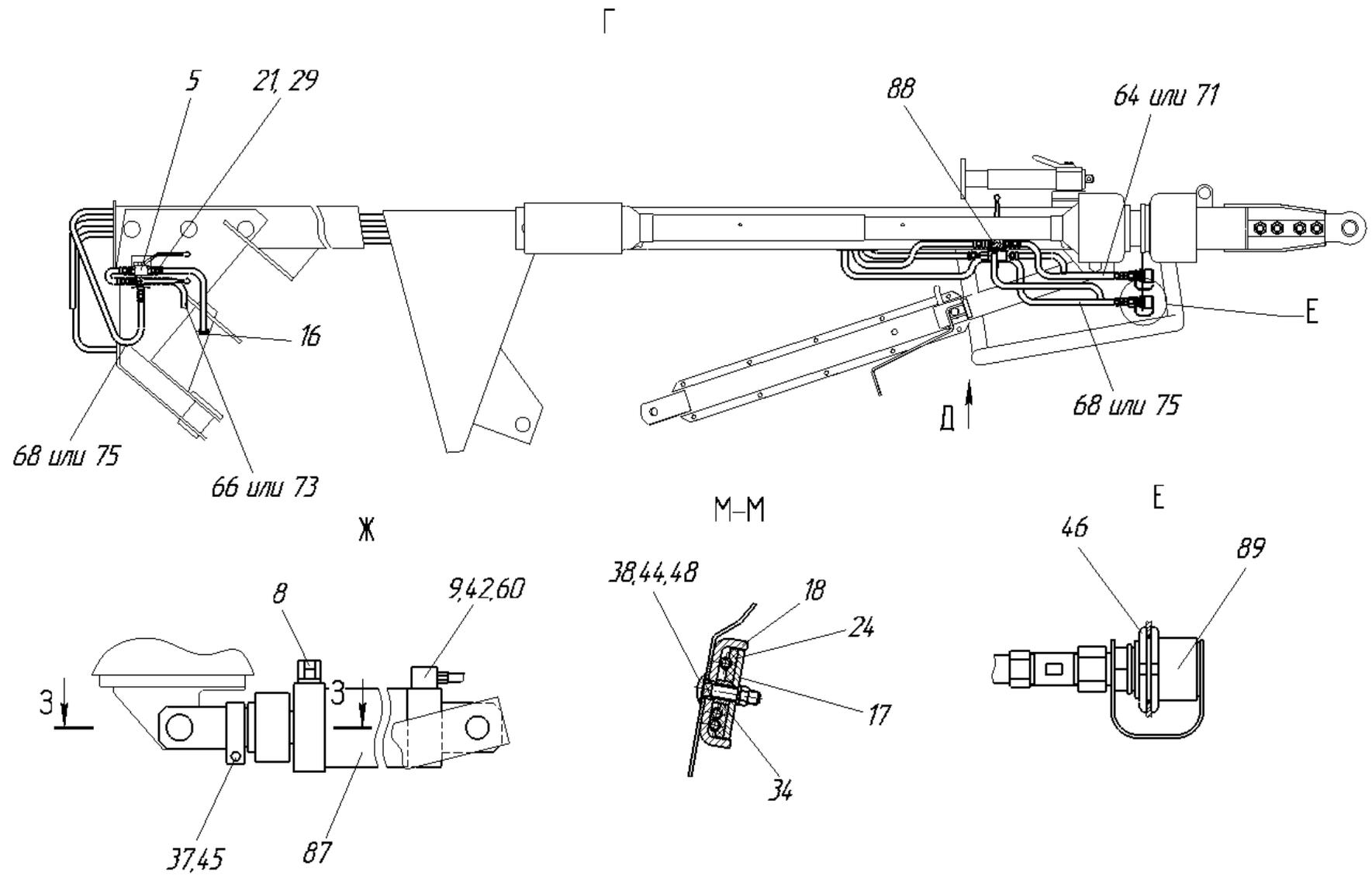
Рисунок 246 – Система гидравлическая ЖВЗ 9800000
