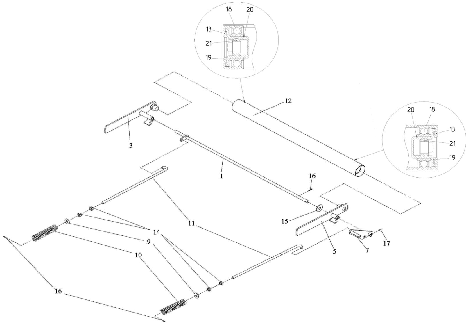
Рисунок 17 – Натяжное устройство ЖВЗ 1220000
