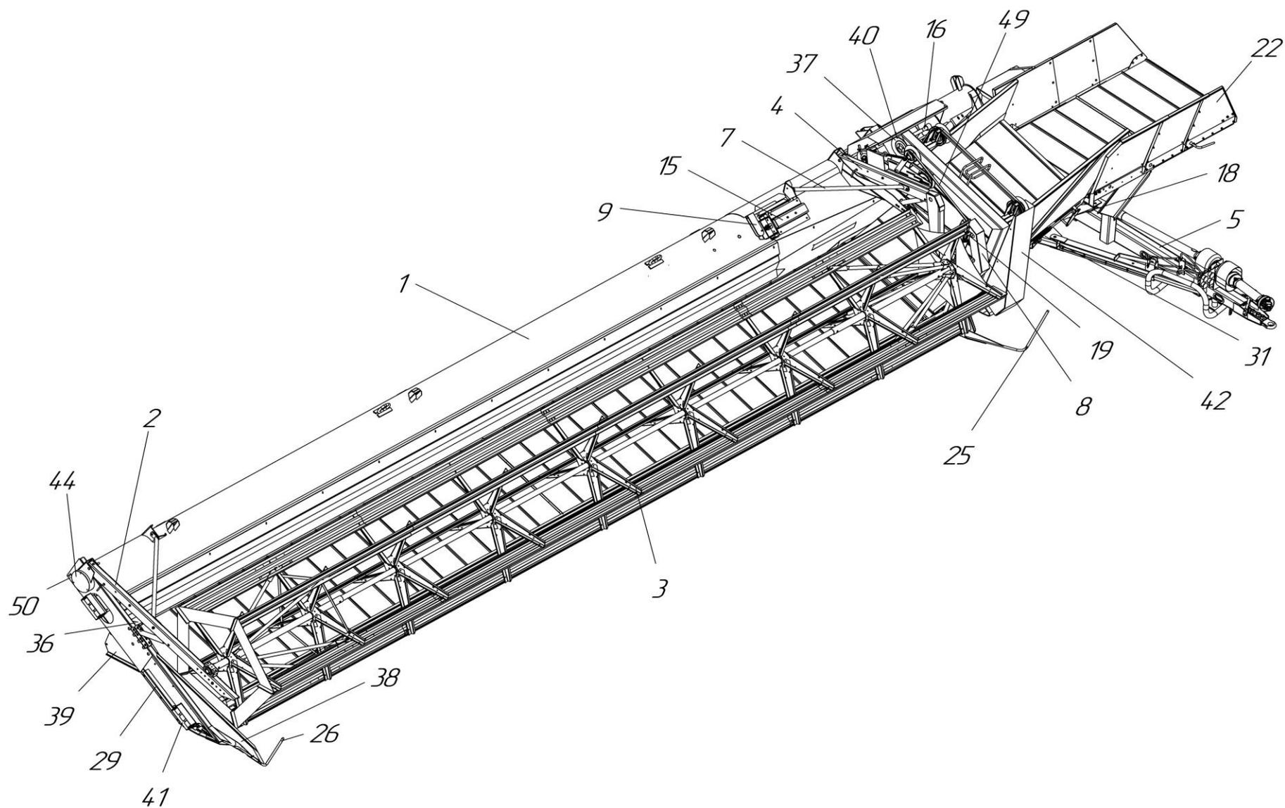
Рисунок 1а – Жатка валковая зерновая ЖВЗ-9,2 (вид спереди)
