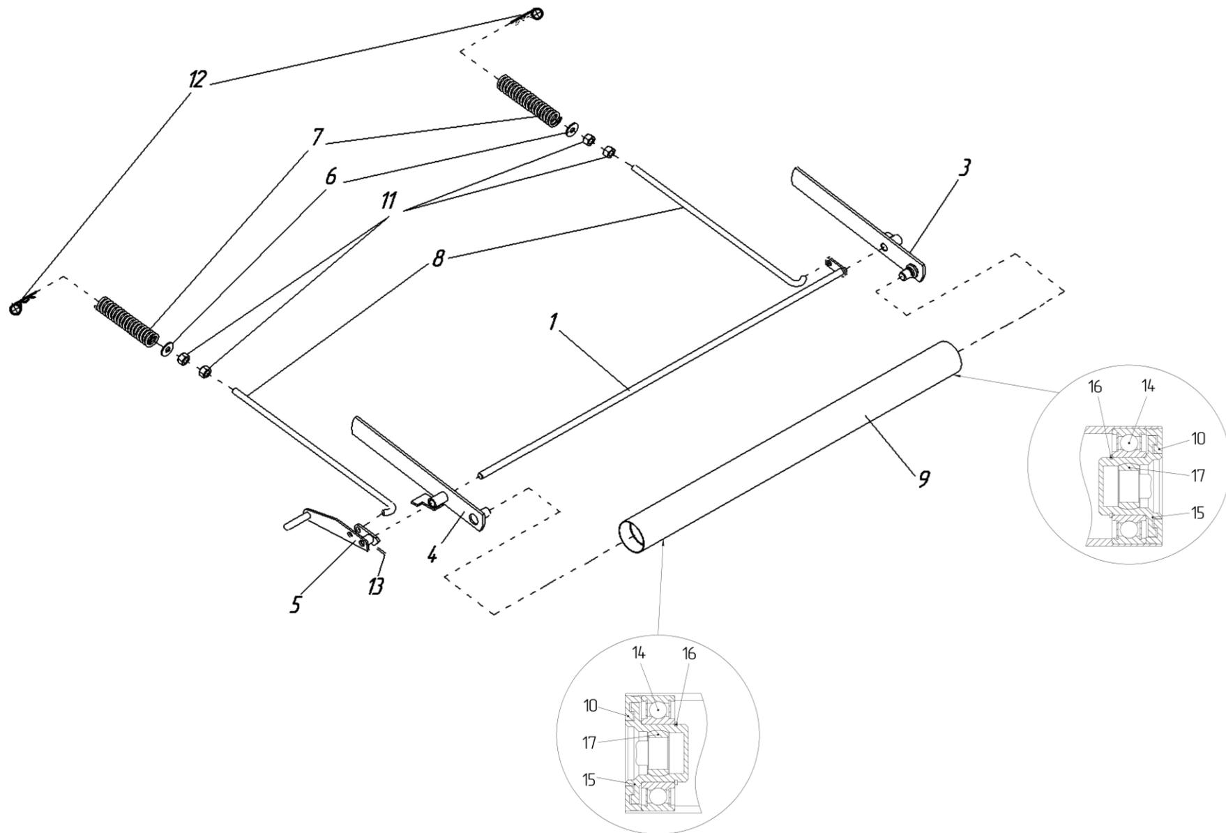
Рисунок 16 – Натяжное устройство ЖВЗ 9220000
