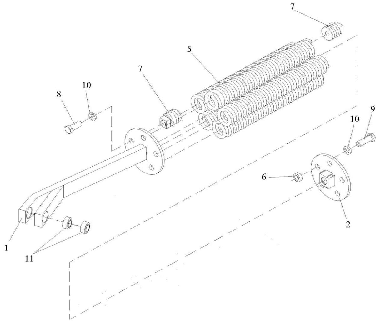
Рисунок 10 – Блок пружин ЖВЗ 1140000
