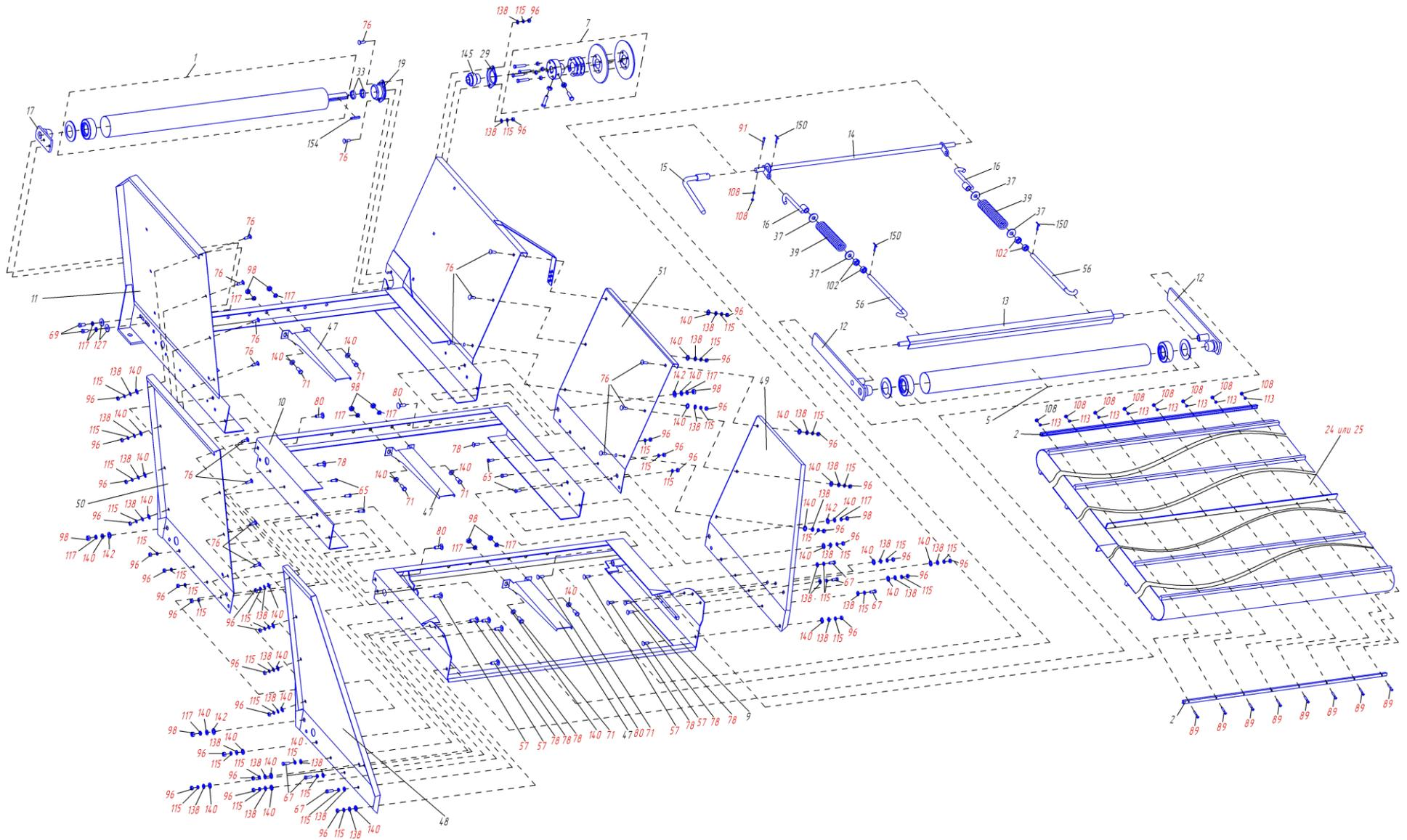
Рисунок 19 – Транспортер выгрузной ЖВЗ 9140000
