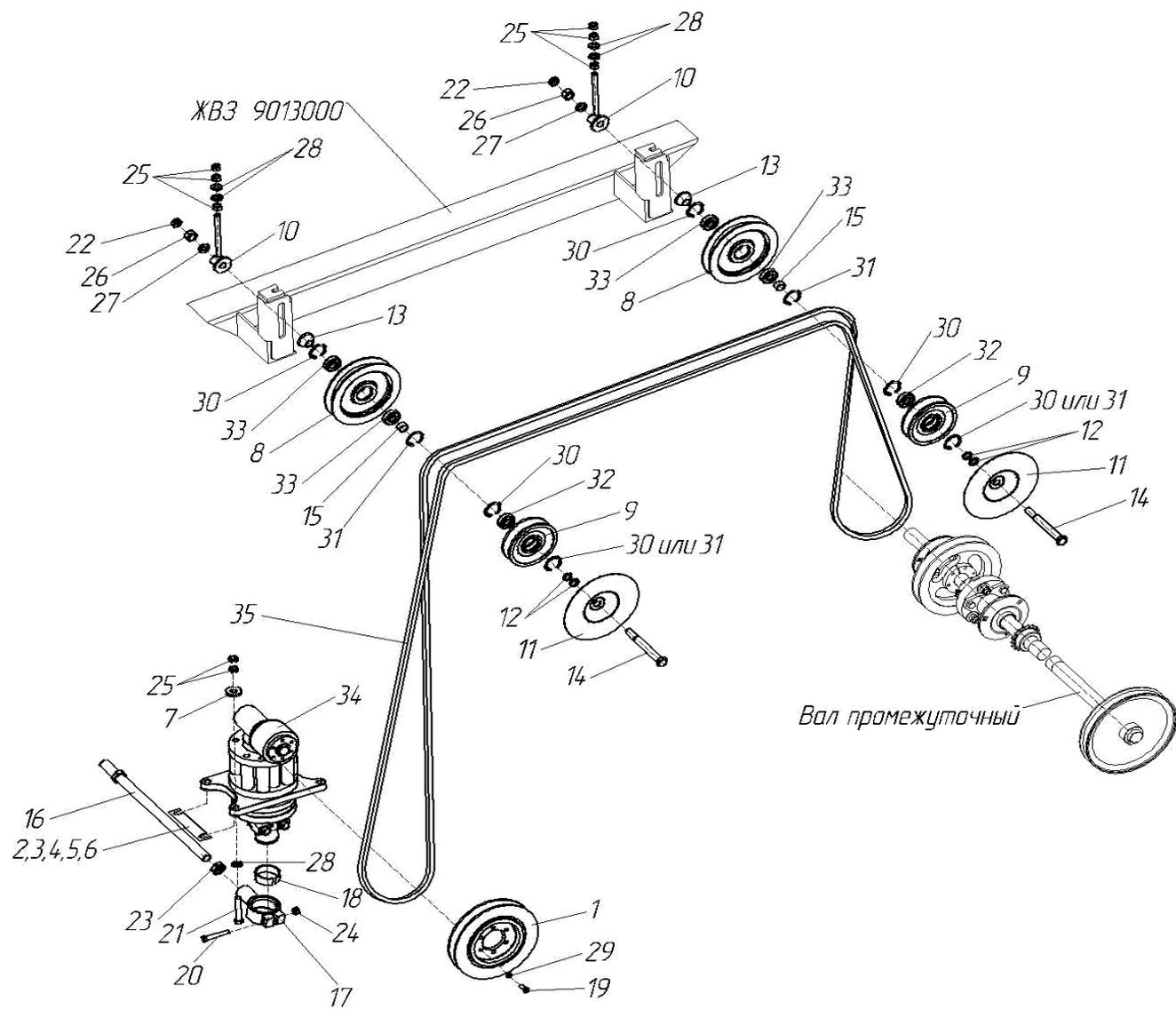
Рисунок 11 – Привод угловой передачи
