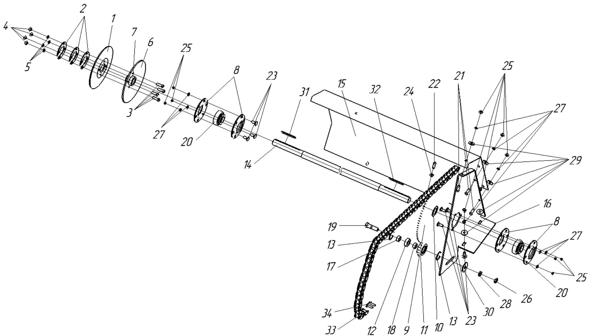
Рисунок 13 – Цепная передача с валом в сборе
