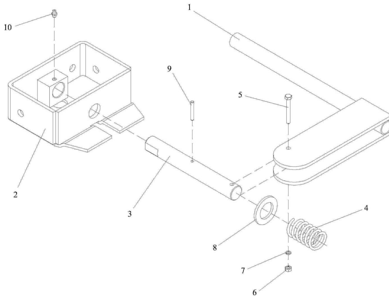
Рисунок 7 – Механизм фиксации колеса ЖВЗ 1090000
