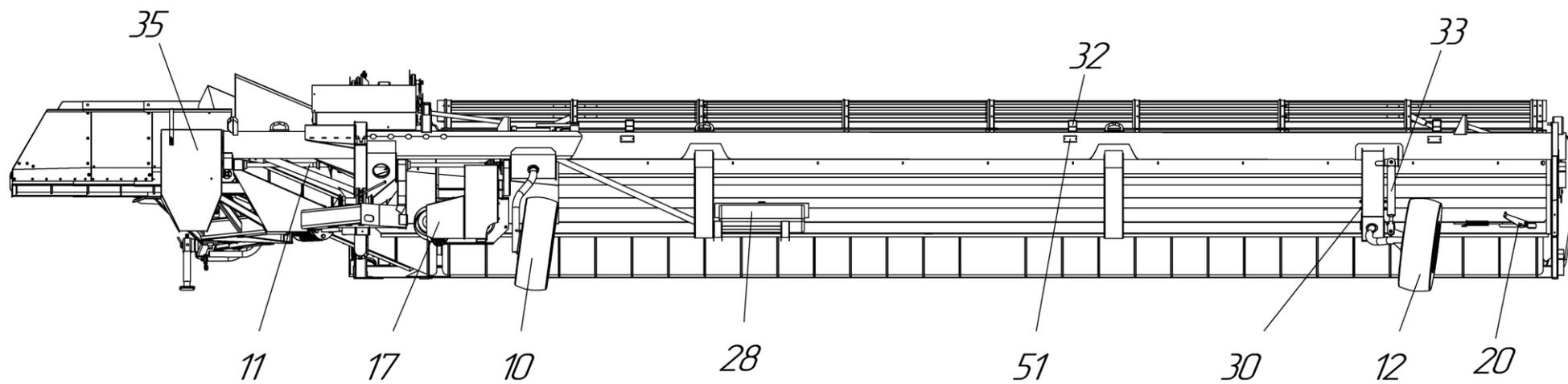
Рисунок 1в – Жатка валковая зерновая ЖВЗ-9,2 (вид сзади)
