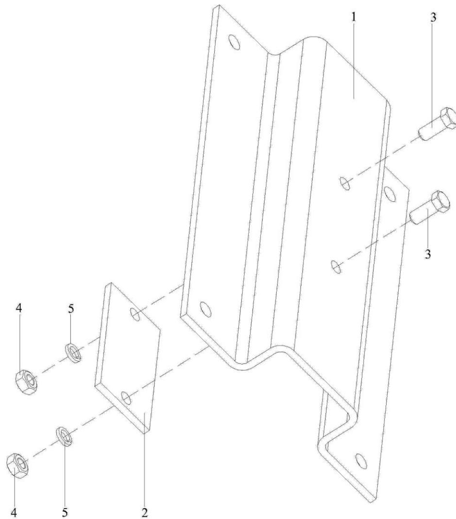
Рисунок 12 – Упор стойки левого колеса ЖВЗ 1170000
