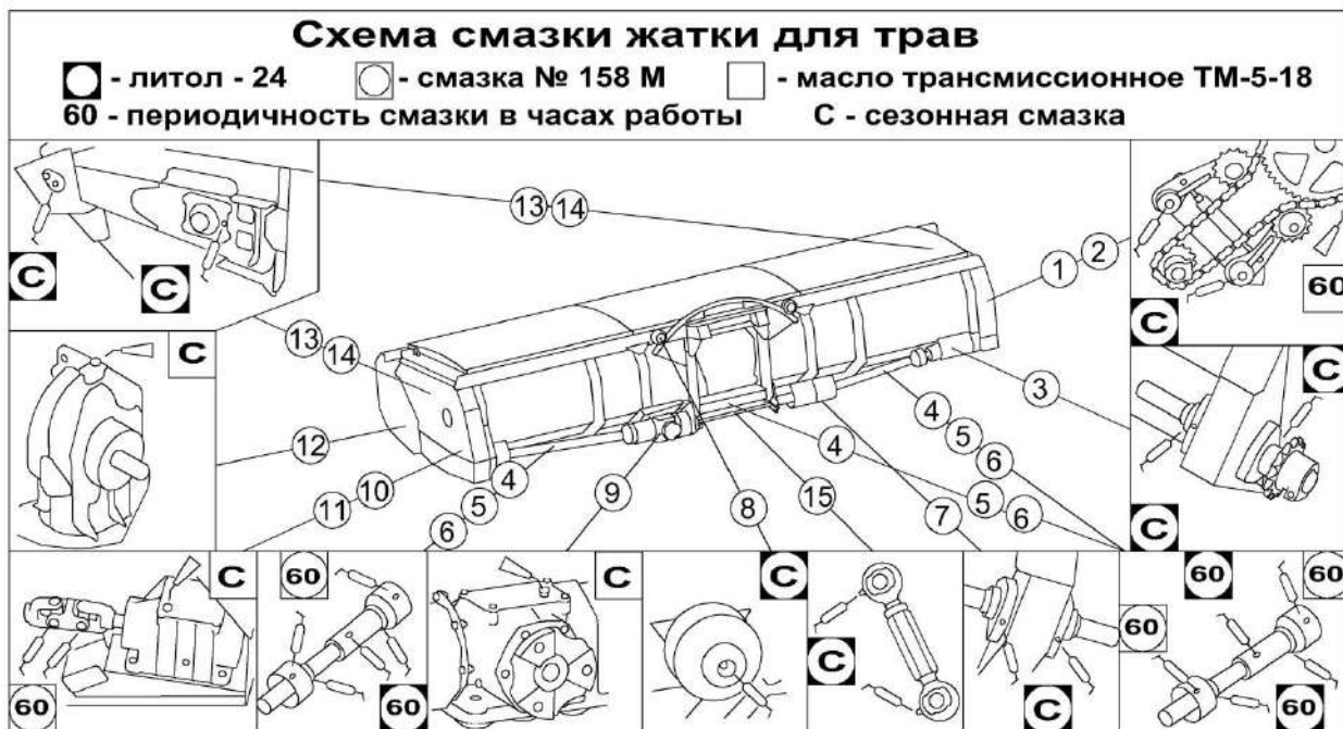
Рисунок 3.1 – Схема смазки жатки
