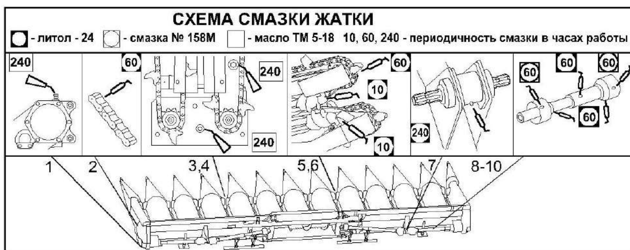
Рисунок 3.1 – Схема смазки жатки
